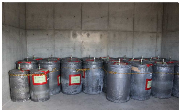
学校等から移動された8000ベクレルを超える指定廃棄物汚泥缶
